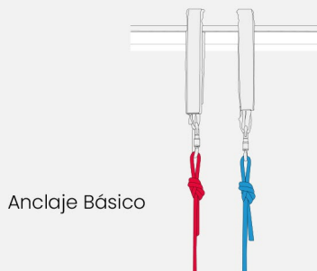
Anclajes simétricos compartidos para mayor seguridad
